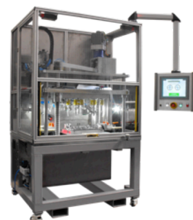
Entwicklung und Herstellung einer Dichtungsprüfzelle für den Zylinderkopf eines AMG Triebwerkes.
